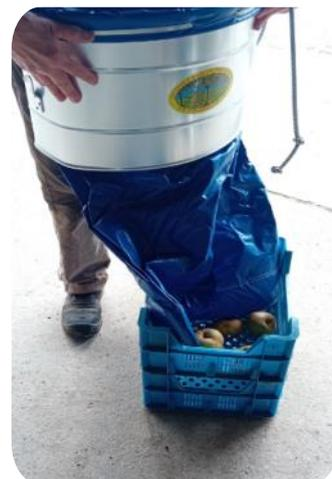
Quand le panier est plein, il suffit de détacher l'extrémité de la chaussette et de la poser dans le cageot : les pommes roulent dans l'entonnoir et se posent dans le cageot.
